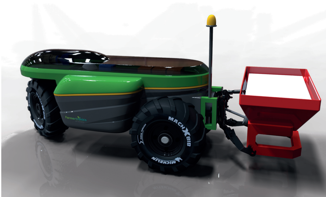
De elektrische smalspoortrekker is ontwikkeld als werktuigdrager en daarom ook voorzien van een hydraulisch systeem
